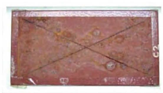
Рис. 4. Лакокрасочное покрытие, содержащее синтетический красный железоксидный пигмент после ускоренных испытаний
