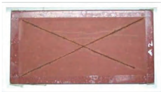
Рис. 3. Лакокрасочное покрытие, содержащее MR 11, после ускоренных испытаний
