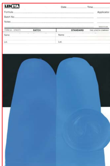
Рис. 2. Проверка совместимости колеровочной пасты с базовой краской с помощью «rub-out»-теста.
